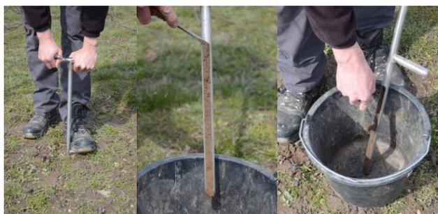
Am einfachsten entnimmt man die Bodenprobe mit einem Bohrstock.
